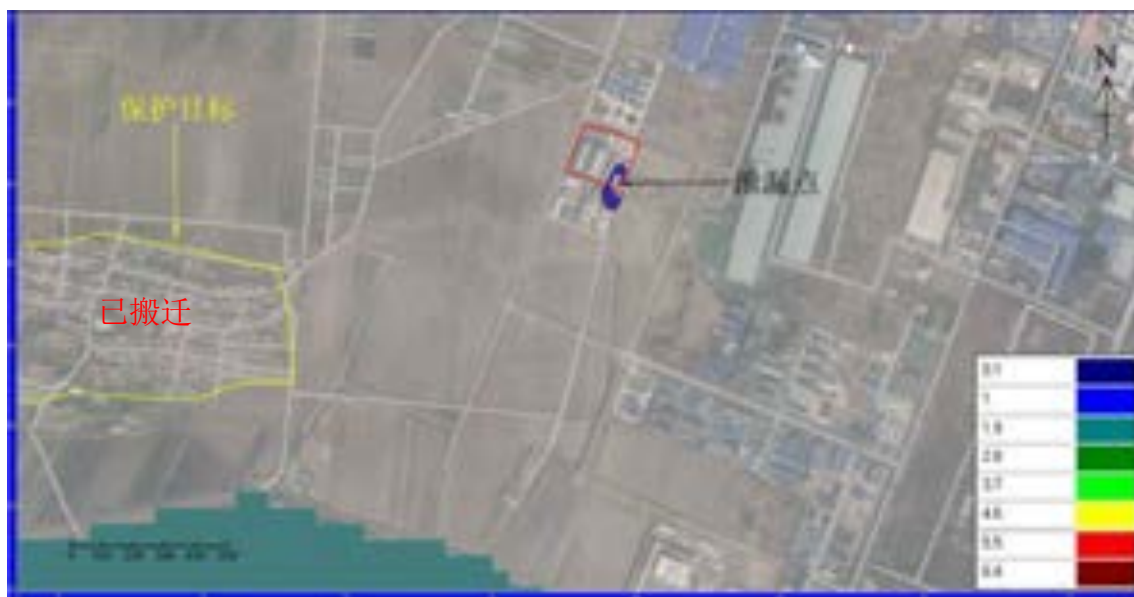
图 6.3-44 渗漏 10 天污染影响范围（苯胺）单位：mg/L
