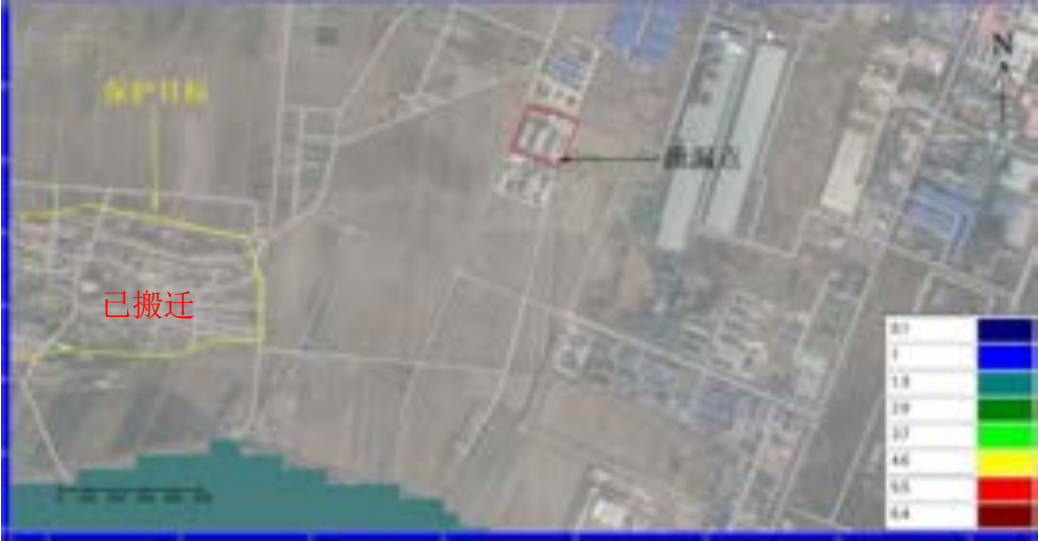
图 6.3-49 渗漏 220 天污染影响范围（苯胺）单位：mg/L
