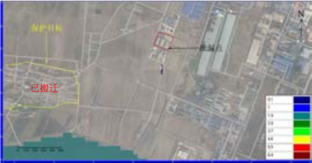
图 6.3-48 渗漏 215 天污染影响范围（苯胺）单位：mg/L
