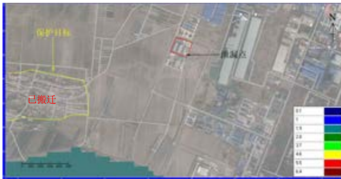
图 6.3-51 渗漏 1000 天污染影响范围（苯胺）单位：mg/L
