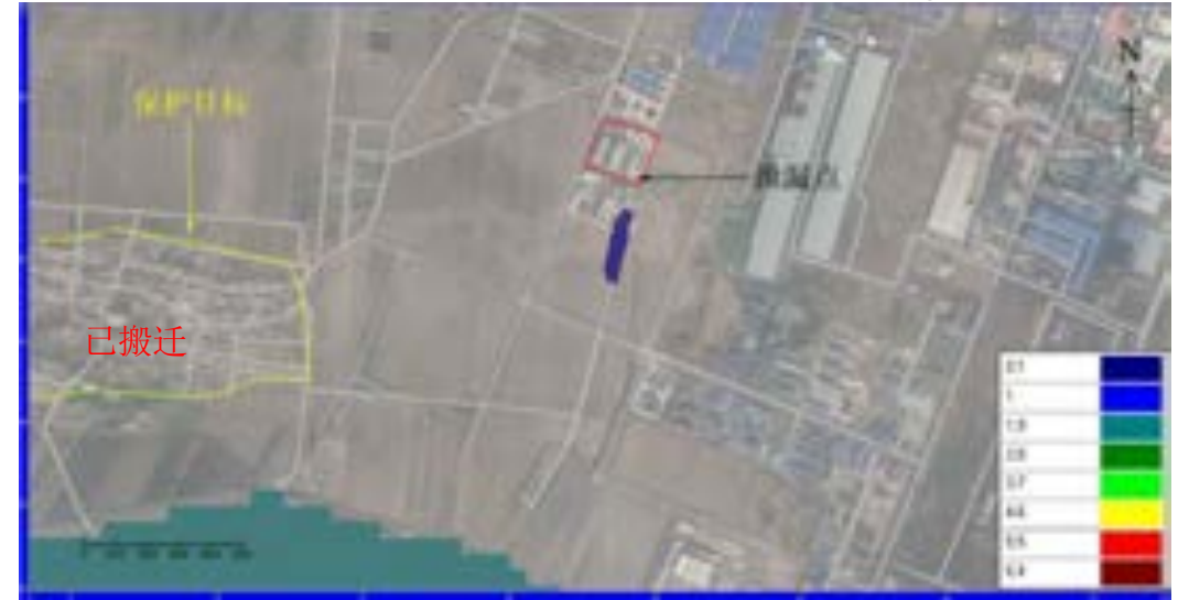
图 6.3-47 渗漏 200 天污染影响范围（苯胺）单位：mg/L
