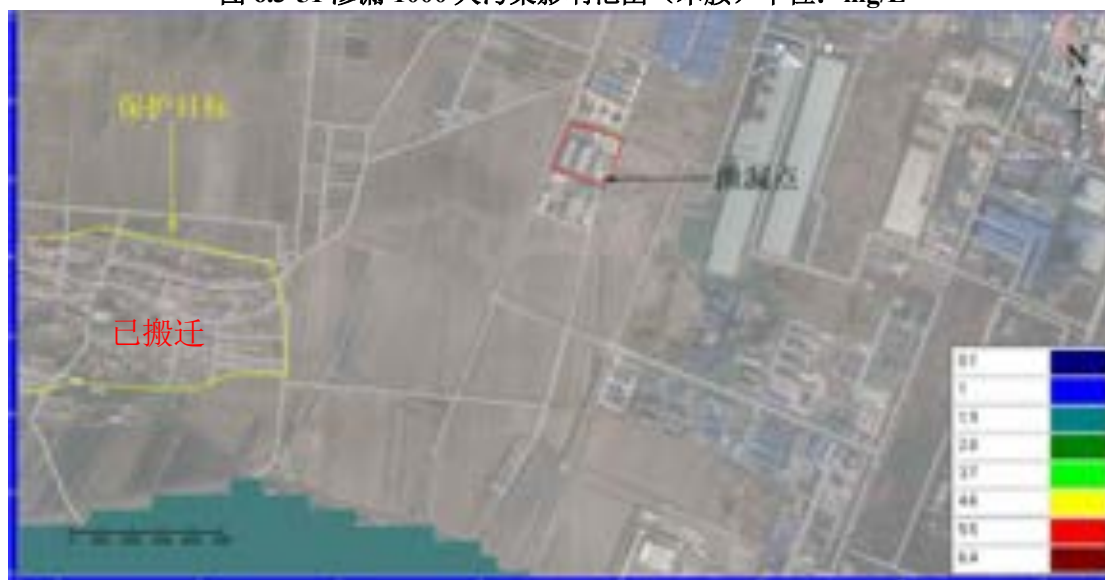
图 6.3-52 渗漏 3650 天污染影响范围（苯胺）单位：mg/L
