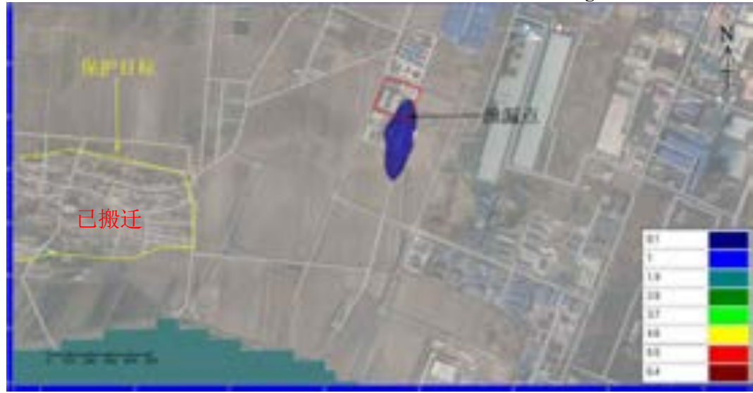
图 6.3-46 渗漏 100 天污染影响范围（苯胺）单位：mg/L
